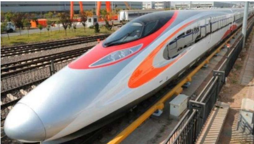
so' del treno è diventato simile al lungo becco del Martin pescatore mentre le ali del pantografo, l'apparecchio posto sulla sommità del treno che riceve energia dai fili della linea elettrica, sono state fatte in modo molto somigliante alle penne del gufo che grazie ad una conformazione particolare riescono a
